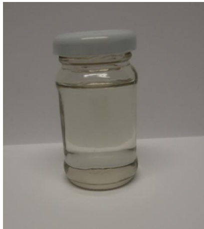
Figura 3. Aceite de coco obtenido de nueces cortadas a madurez fisiológica, sin testa, secado al horno, molido después de secado y extraído en prensa de acero inoxidable
