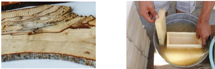
Figura 4. Pieza apolillada y uso de productos con pentaclorofenol en el tratamiento de la madera de linaloe.
