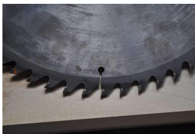
Figura 3. Sierra circular recomendable para el corte de la madera de linaloe.
