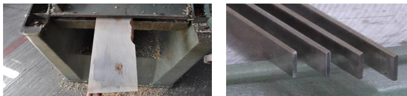
Figura 2. El cepillado de linaloe con las cuchillas apropiadas.
