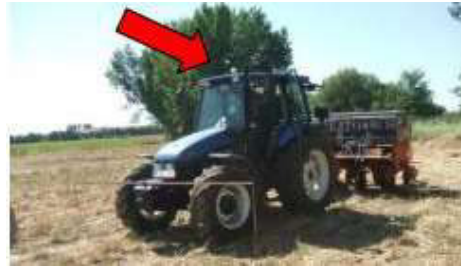
Figura 3. Ubicación de GPS para monitoreo de separación entre plantas
