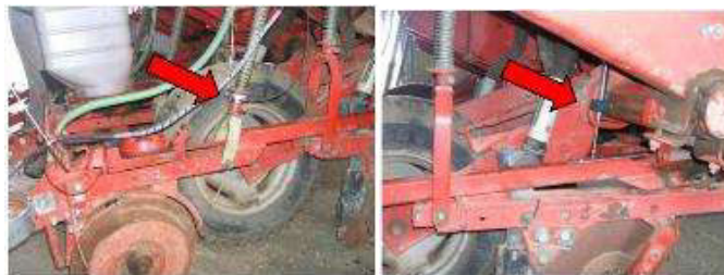
Figura 2. Ubicación de la celda de carga, LVDT y sensor para paso de semilla
